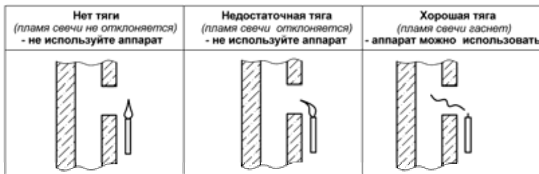
Рисунок 4. Способ проверки тяги в дымоходе
